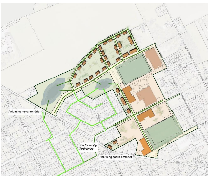
Föreslagen dagvattenhantering för planområdet. Ljusgröna linjer är bef. dagvattenledningar. Mörkgröna linjer förslag på nya ledningar/kopplingar.
