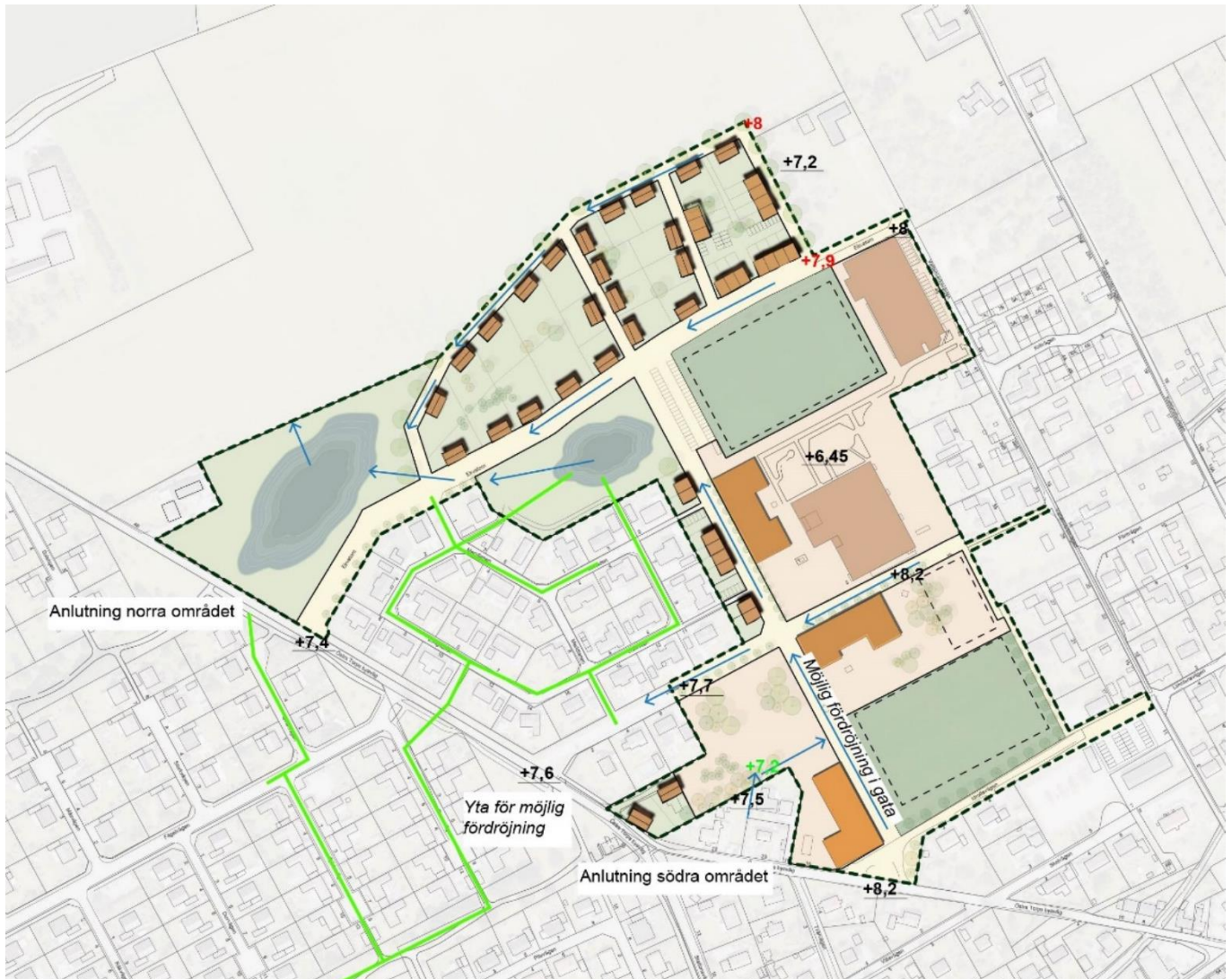
Bild visar avrinningsvägar inom det södra avrinningsområdet och grov uppskattning av marknivåer för att möjliggöra ytliga avrinningsvägar. Röda höjdmärkingar indikerar markhöjning, gröna höjder marksäkning och svarta understrukna höjder redovisar befintliga höjder.
