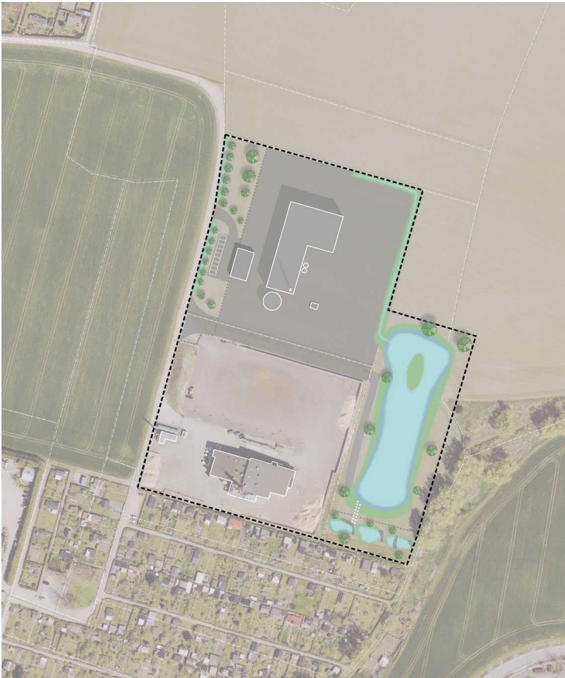
Illustrationsplan som visar en möjlig utformning av området. Befintlig fjärrvärmearläggning är i söder. Ny anläggning är i norr. I öster illustreras de olika dagvatten- samt skyfallsanläggningarna.
