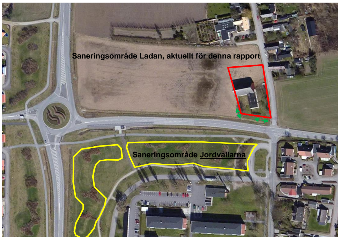
Figur 1.1 Översiktsbild över undersökningsområdet. Röd linje visar sanerings/arbetsområdet, Ladan, föreliggande rapport. Grön linje visar kvarlämnade jordmassor längs med befintlig ledning/egenskapsgräns samt administrativ gräns och med halter över ÅM-KM. Inga förorenade massor över ÅM-KM har kvarlämnats i schaktbotten. Kvarlämnade jordmassor har av tekniska skäl kvarlämnats och är förankrade med miljöavdelningen i Trelleborg. Gul linje visar saneringsområdet Jordvallarna , och redovisas i separat rapport Källa: Eniro.se
