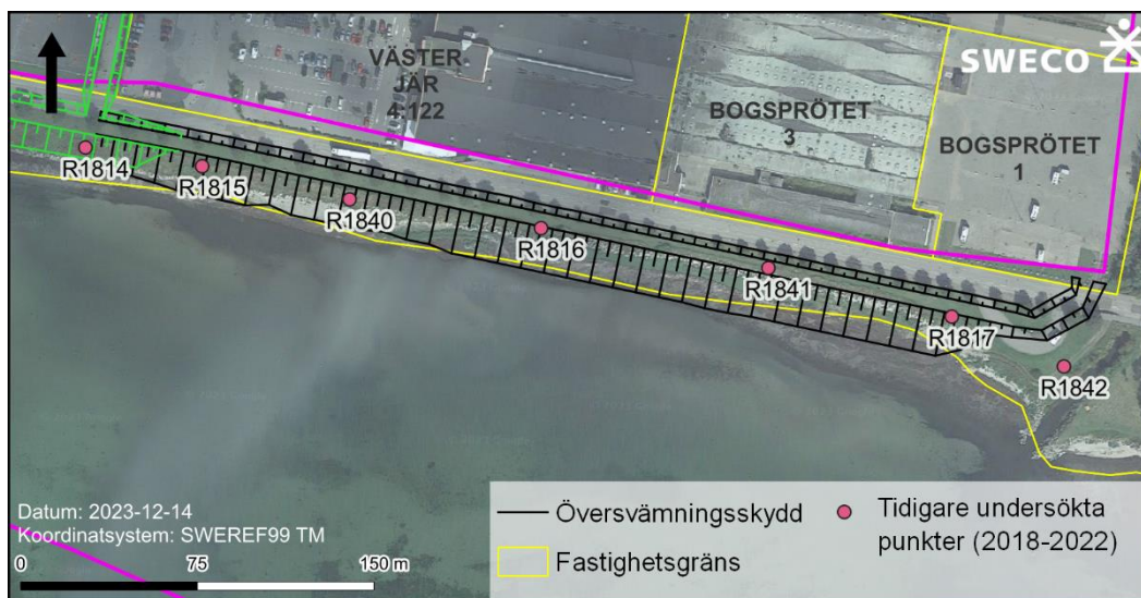
Figur 152. Relevanta provpunkter från tidigare provtagning (Ramböll, 2019) som sammanfaller direkt med översvämningsskyddets östra del eller ligger väldigt nära. Punkterna R1838, R1840 och R1842 har undersökts för geoteknik, punkt R1841 för grundvatten, och punkterna R1814 , R1815 , R1816 och R1817 för miljöteknisk markundersökning. Ytterligare en provtagningspunkt finns för fastigheten Bogsprötet 3 (skifte 1) södra del där tidigare industriverksamhet fanns (R1826).
