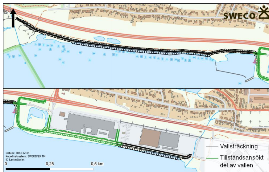
Figur 43. Sträckan för den redan tillståndsgivna delen av översvämningsskyddet (Mål nr M 5557-22) visas i grönt och nytillkomna sträckor (planerade vattenverksamheter som omfattas av detta samråd) av översvämningsskyddet visas i svart (västra delen = översta bilden och östra delen = nedersta bilden).
