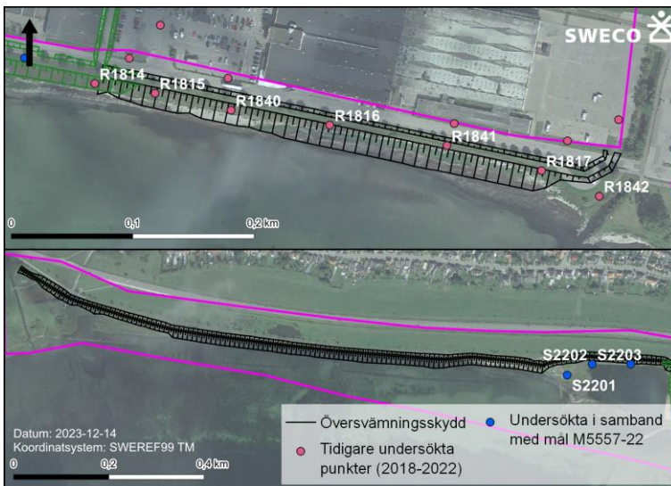
Figur 131. Berörda delsträckor av översvämningsskyddet, östra delen (ovan) och västra delen (nedan). Röda punkter markerar lägen för provtagningspunkter från 2018–2022 (Ramböll, 2019), (Sweco, 2022c)). Delsträckan där emellan (i grönt) är redan tillståndsgiven.
