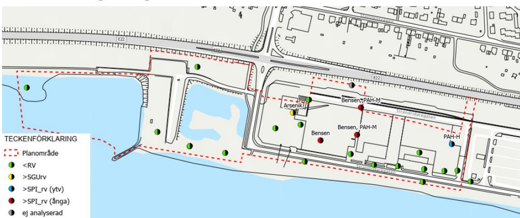
Figur 139. Föroreningsituation i jord och grundvattenprov enligt tidigare undersökningar inom ramen för prövning av Mål nr M 5557-22 (Sweco, 2022d). Provpunkter i närheten av småbåtshamnen är representativa för nu planerad verksamhet (översvämningsskyddets västra del).
