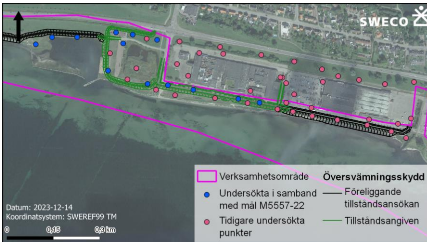
Figur 128. Tidigare miljötekniska markundersökningar. Planerade översvämningsskydd markeras med svart (aktuella delar i föreliggande samrådsunderlag) och grönt (redan tillståndsgivet översvämningsskydd enligt dom i Mål nr M 5557-22). Rosa prickar markerar provtagningspunkter som undersökts i samband med planprogram Västra sjöstaden (Ramböll, 2019), (Sweco, 2022c)). Blåa prickar markerar provtagningspunkter som har undersökts i samband med prövning av mål nr M 5557-22, i syfte att utreda föroreningsituationen för översvämningsskyddets läge (Sweco, 2022d)).
