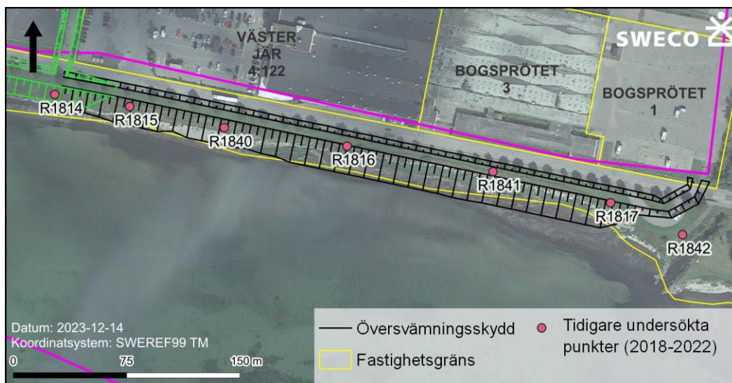
Figur 132. Relevanta provpunkter från tidigare provtagning (Ramböll, 2019) som sammanfaller direkt med översvämningsskyddets östra del eller ligger väldigt nära. Punkterna R1838, R1840 och R1842 har undersökts för geoteknik, punkt R1841 för grundvatten, och punkterna R1814, R1815, R1816 och R1817 för miljöteknisk markundersökning. Ytterligare en provtagningspunkt finns för fastigheten Bogsprötet 3 (skifte 1) södra del där tidigare industriverksamhet fanns (R1826).
