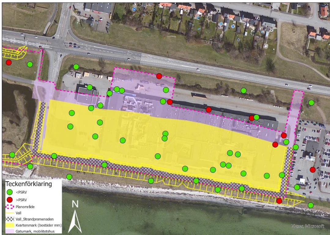
Figur 143. Planerad vall, vid Strandpromenaden, där haltkriterier för bostadsmark kommer att tillämpas. PSV=platsspecifika riktvärden för jord som framtagits för Västra sjöstadens. (Sweco, 2023d)
