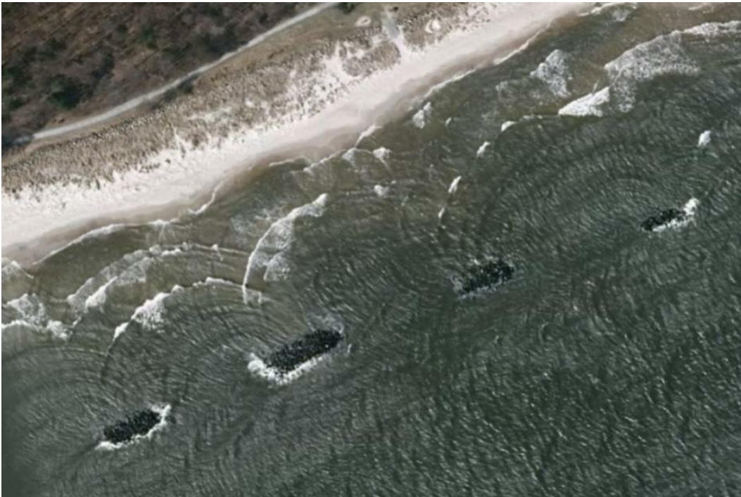
Figur 3-4 Konventionella friliggande vågbrytare i Ystad. På bilden syns tydliga diffraktionsmönster och ett strandplan med våguddar.
