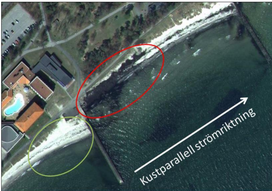
Figur 3-3 Hövder vid Ystad Saltsjöbad. På bilden syns tydligt att sand ansamlas på den västra (uppströms) sidan (grönt fält) och eroderas på den östra (nedströms) sidan (rött fält)
