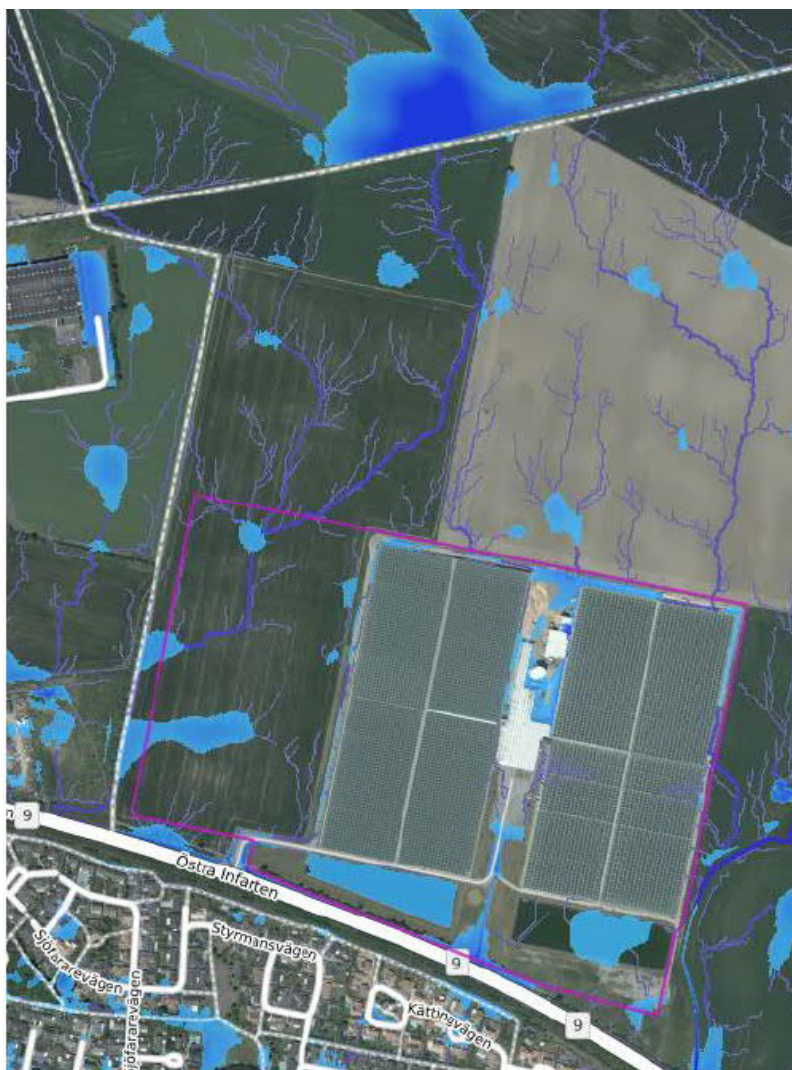
Figur 5-7 Lågpunktskartering vid skyfall. Stående vatten under 10 cm visas som ljusblåa ytor och djupare vatten som mörkblåa ytor.
