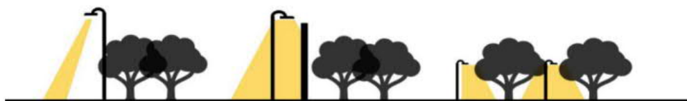
Figur 5-5 Lampor som kan riktas och bara lysa upp det som är avsett (exempelvis vägbanan) minskar mängden onödigt ljus. Samma effekt kan uppnås genom avskärmning eller genom att låta lampor placeras på lägre höjd.
