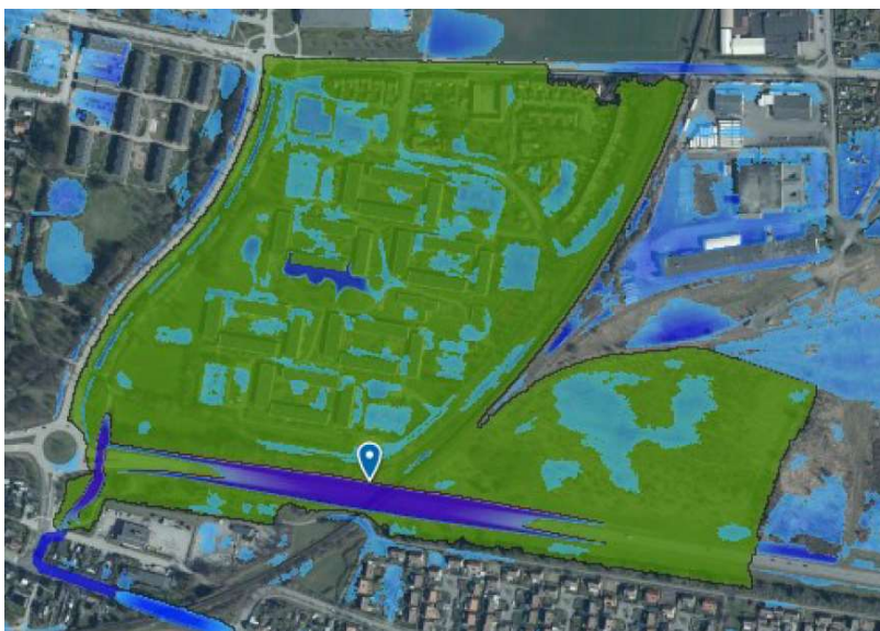
Maximal avrinning mot markerad lågpunkt på väg 9.
