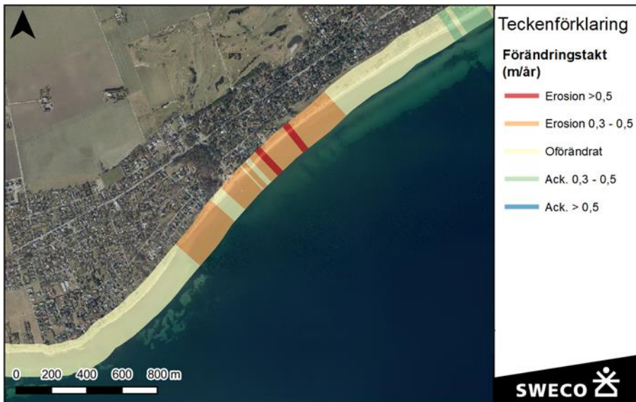
Figur 7. Beräknad erosionstakt i Beddingestrand under tidsperioden 1960-2020.
