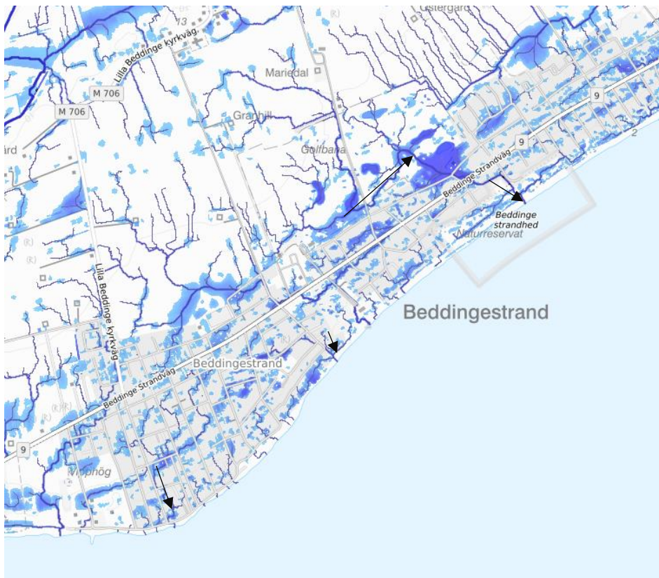
Figur 15 Befintliga ytliga avrinningsvägar och instängda områden i Västra Beddingestrand. Bilden är ett skärmbild från Scalgo Live.
