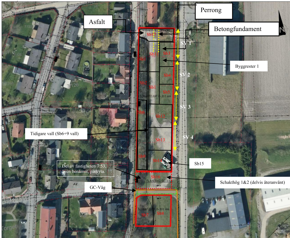
Figur 5.5 Översiktlig situationsplan över saneringsområdet. Inom arbetsområdet har ett flertal ledningar påträffats och enligt överenskommelse med Tekniska Serviceförvaltningen i Trelleborgs kommun, har dessa grävs upp, lagts om alt. tagits bort. I samband med anläggning av ny GC-väg, påträffades gamla slipers, slagg m.m. inom området benämnt "parkyta". På Trelleborgs miljöenhets begäran, har även denna yta sanerats. Längs juridisk tomtgräns i öst, har halter strax över KM delvis lämnats kvar i schaktvägg, SV2 och SV4. Röd streckad linje visar ungefärligt aktuellt arbetsområde. Svarta linjer visar indelning av ytor om max 400m 2 .
