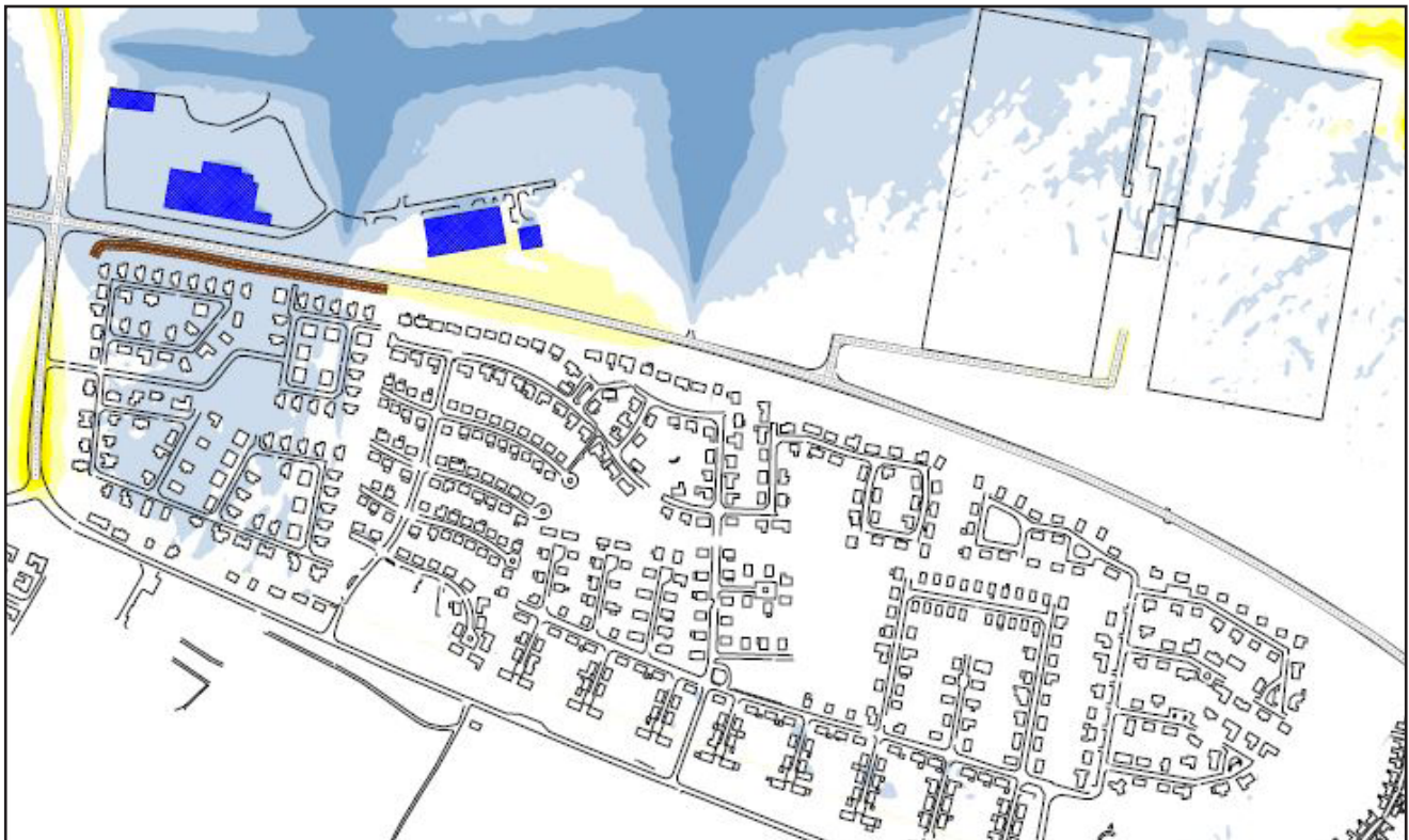
Bilden visar på nollalternativscenario (ingen exploatering, år 2040). Vid ett nollalternativscenario påvisas en skillnad på 3 dBA mellan genomförandet av detaljplanen och inget genomförande.
