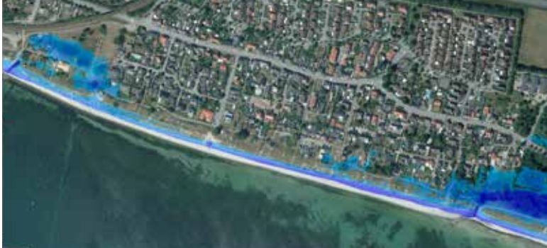
Översvämningsrisk för byggd miljö vid en hundraårshändelse 2025 (+1,85 m).
