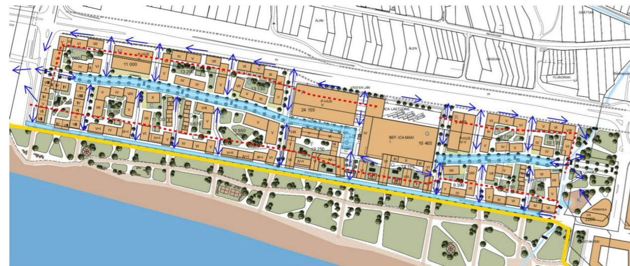
Figur 2. Kartan visar principer för höjdsättning. Röd streckade linjer visar högpunkt. Gul linje visar kustskydd. Ljusblå polygon visar platta lågstråk. Blå pilar visar lutning och flödesriktning för skyfall.
