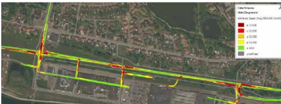
Heatmap som visar hur trafiksituationen ser ut med tillkomna korsningspunkter på E6. Medelhastighet på eftermiddagen.
