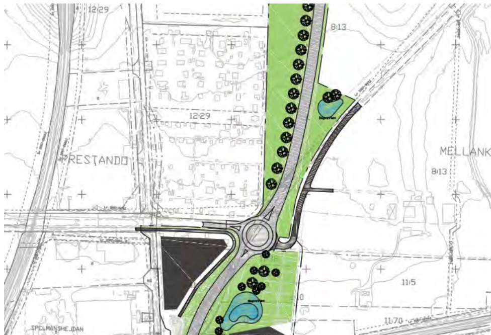
Figur 7.41. Illustration av Östra ringvägens korsning med Engelbrektsgatan/Dalköpinge byaväg, se E i Figur 4.1. Figuren visar förslag på plats för ny allé inom nya naturytor mellan Östra ringvägen och koloniområdet. En liknande lösning planeras för nya naturytor mellan Östra ringvägen och Rättspsykiatriskt centrum.
