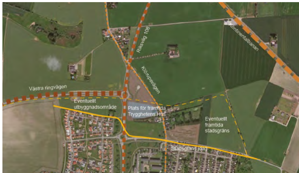
Figur 7.11. Översikt över befintlig cirkulationsplats norr om Trelleborg där den västra delen av ringvägen ansluter till väg 108. Östra ringvägen kommer att anslutas till befintlig cirkulationsplats.
