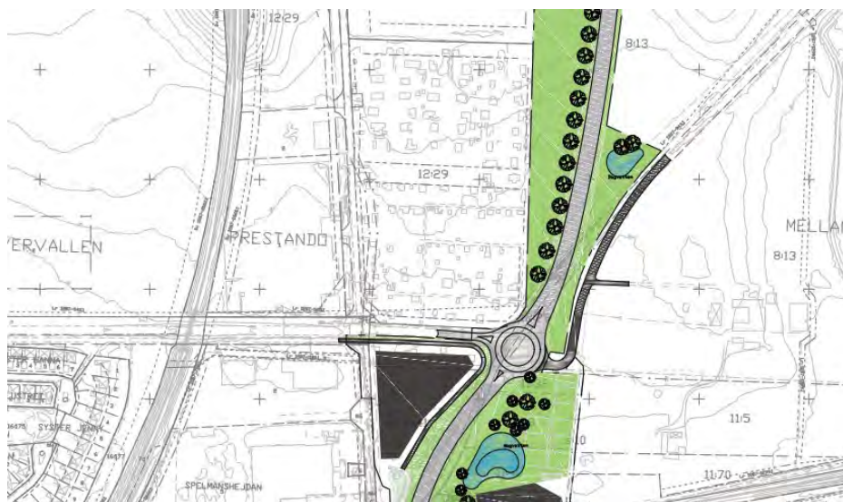
Figur 6.19. Illustration av korsningen mellan Östra ringvägen och Engelbrektskatan/Dalköpinge byaväg enligt alternativet cirkulationsplats.
