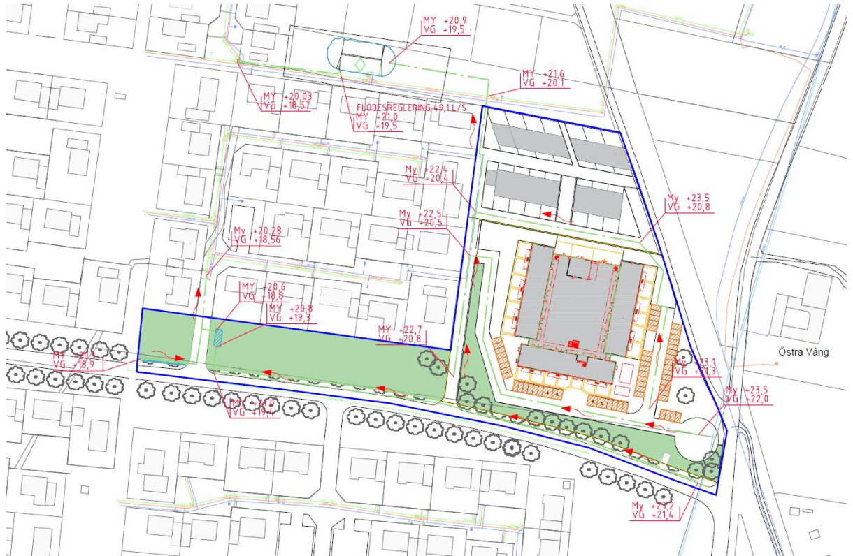
Figur 15. Storlek av öppet dike norr om Delavrinningsområde A för hantering av ett 20-årsregn (markerade i blå polygon). Se bilaga 1.
