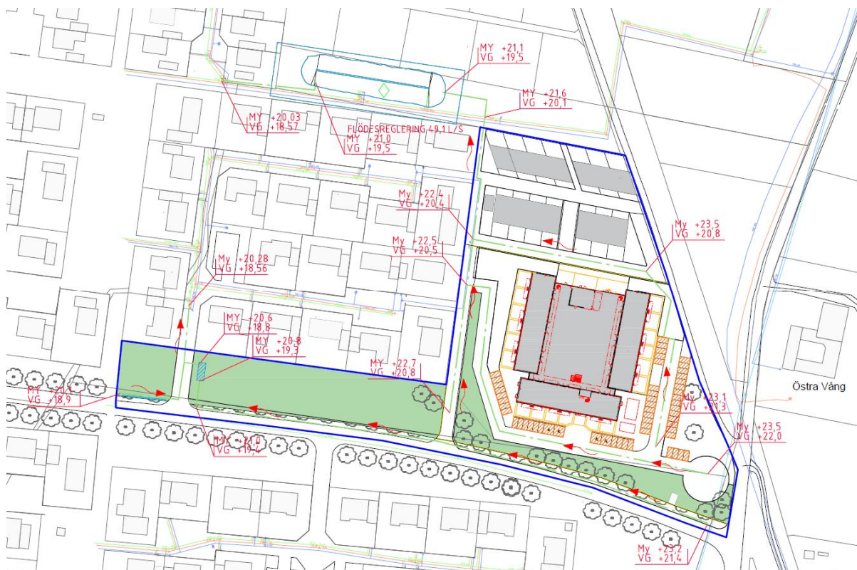
Figur 16. Storlek av öppet dike norr om Delavrinningsområde A för hantering av skyfallsvatten (markerade i blå polygon). Se bilaga 2
