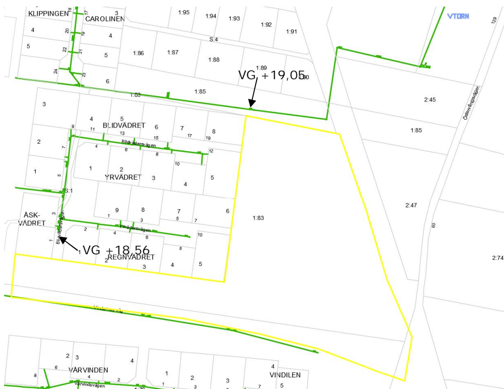
Figur 5. Befintliga dagvattenledningar (grön linje). Planområdet är markerat med gul polygon.
