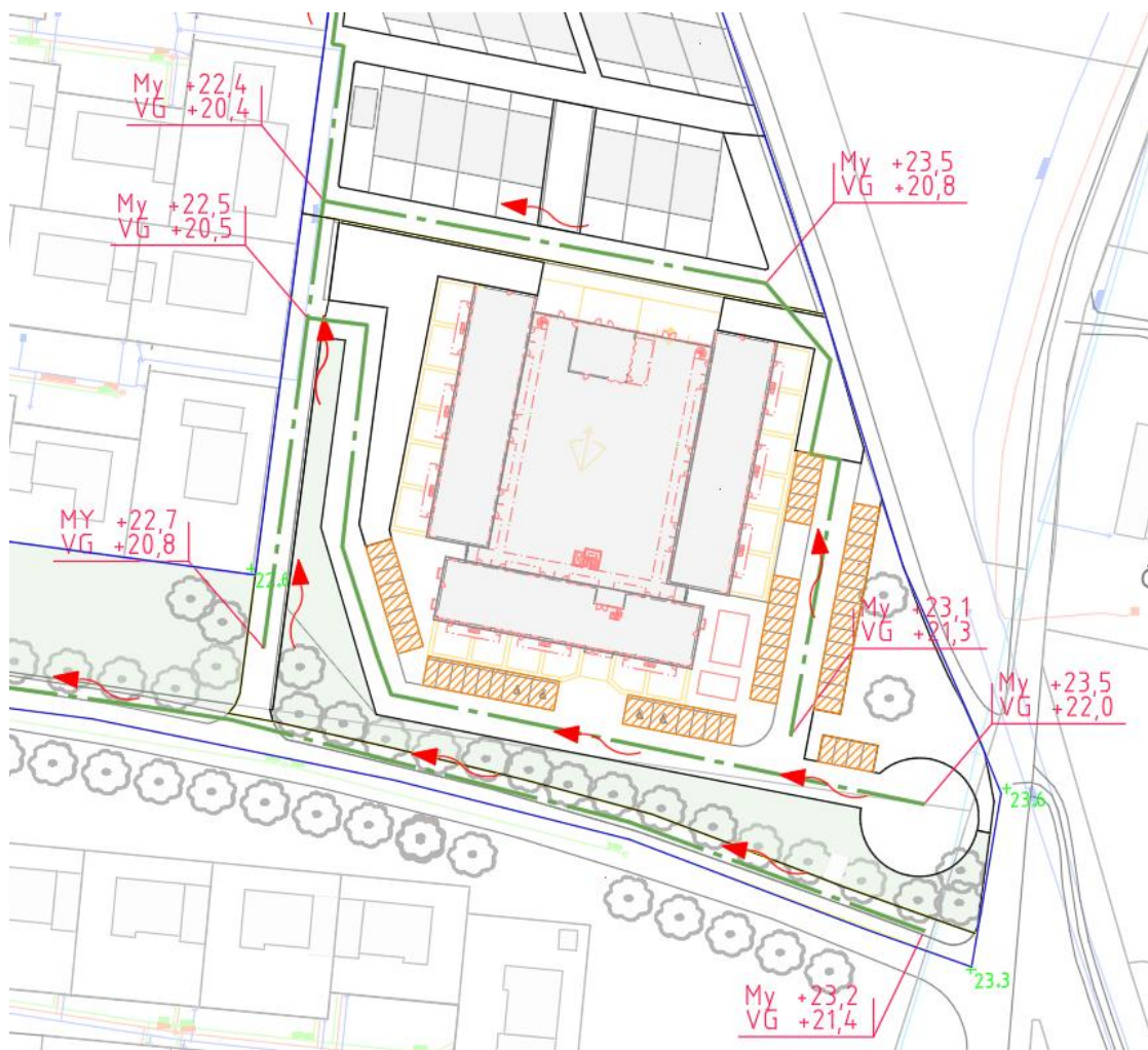
Figur 14. Placering av makadammagasin under parkeringsplatser vid Bovieran (skrafferade polygon i orange). Gröna streck visar föreslagna dagvattenledningar och röda pilar rinnvägar.
