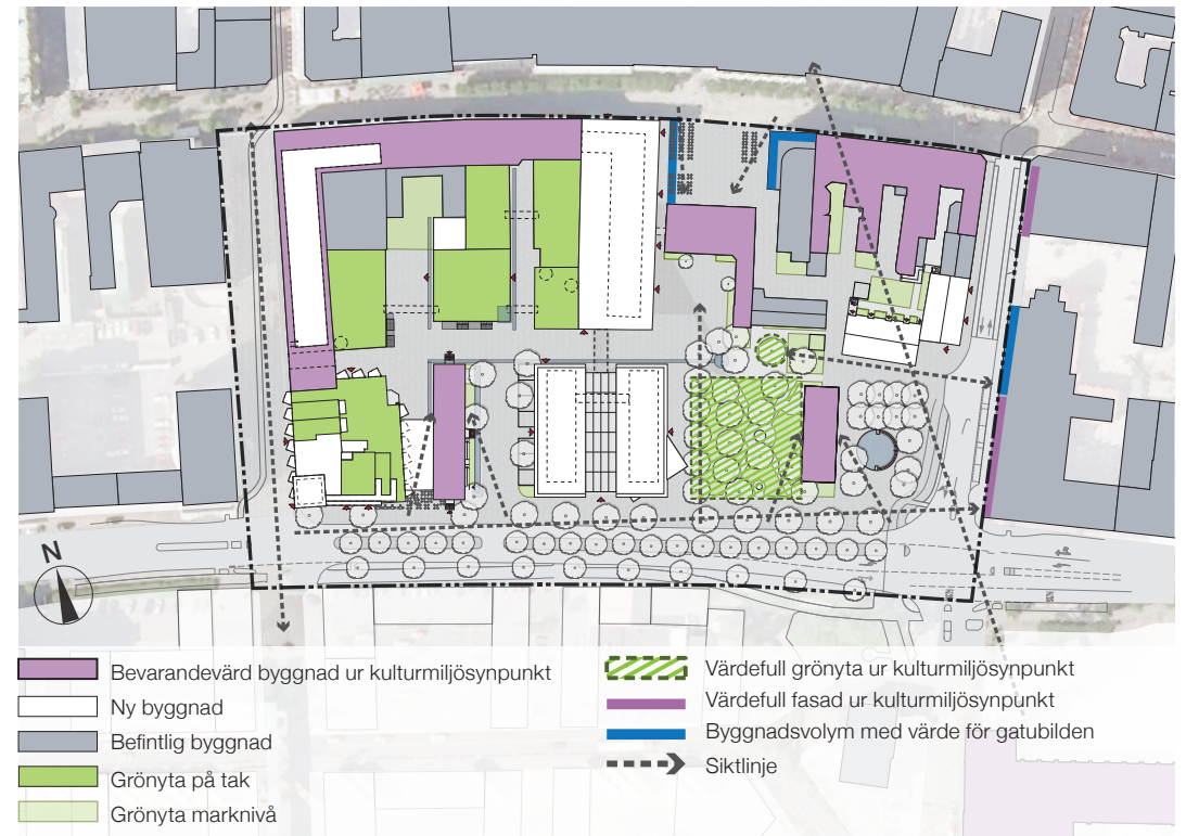
Siktlinjer mot historiska byggnader och grönska
