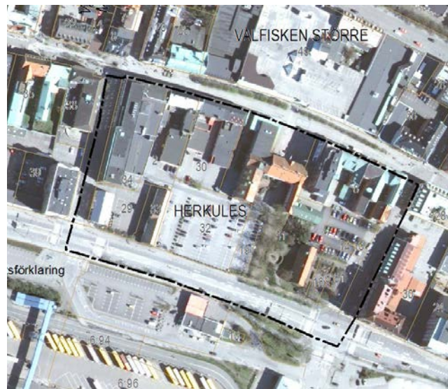
7150 kvm asfalterad yta ändras till ca 4000 kvm plattlagd bruksgata, ca 130 nya lägenheter, ca 300 arbetsplatser. Grönyta inom kvarteret ökar med ca 1200 kvm.
