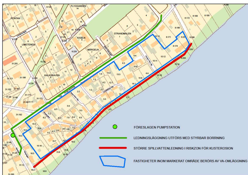
Figur 13-1 Byggnation av nya klimatsäkrade ledningar i Smygehamn.
