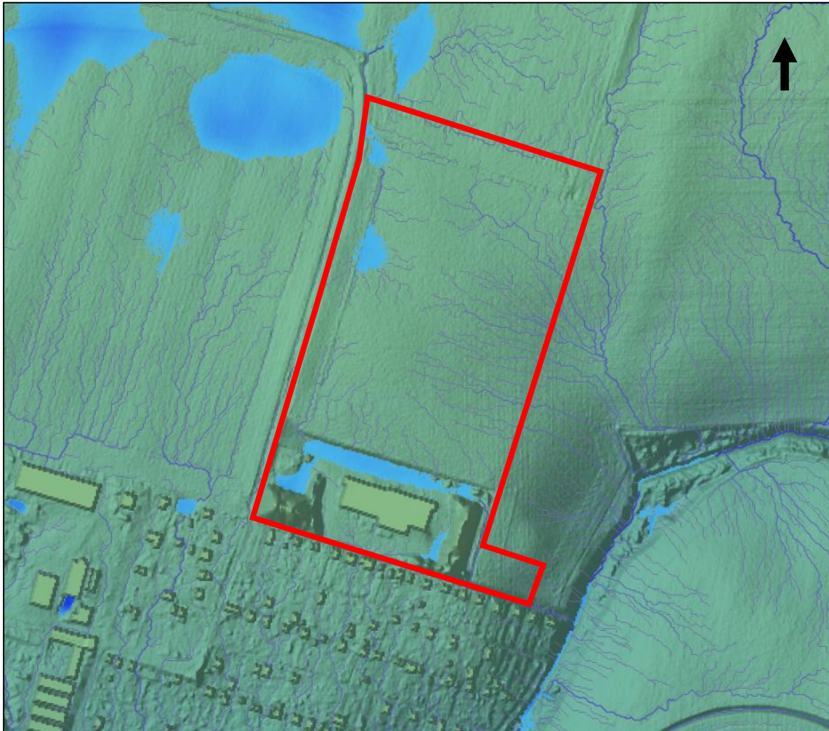
Figur 13. Områden som riskerar att översvämmas i samband med skyfall (nederbördsmängd 50 mm). Röd polygon visar utredningsområdets utbredning. Blå områden visar befintliga instängda områden inom och utanför utredningsområdet, blå linjer visar sekundära avrinningsvägar. Kartbild hämtad från SCALGO Live 2022-11-06.
