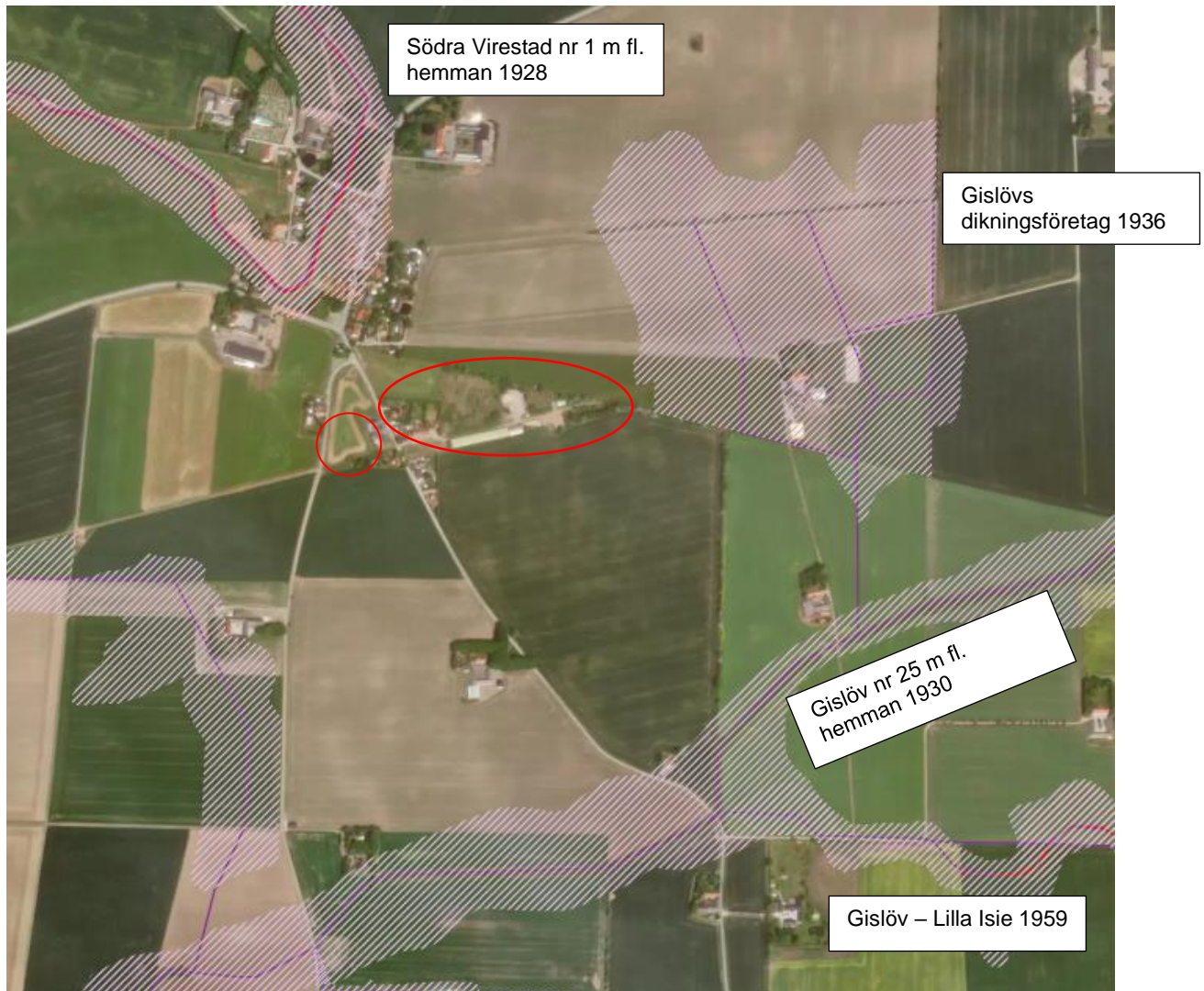
Figur 4. Översikt som visar markavvattningsföretag i närheten av detaljplanerna. Skrafferade ytor visar båtadsområdet och lila eller röda linjer visar diken eller ledningar som ingår i dikningsföretaget. Planområdenas lägen är inringade i rött.
