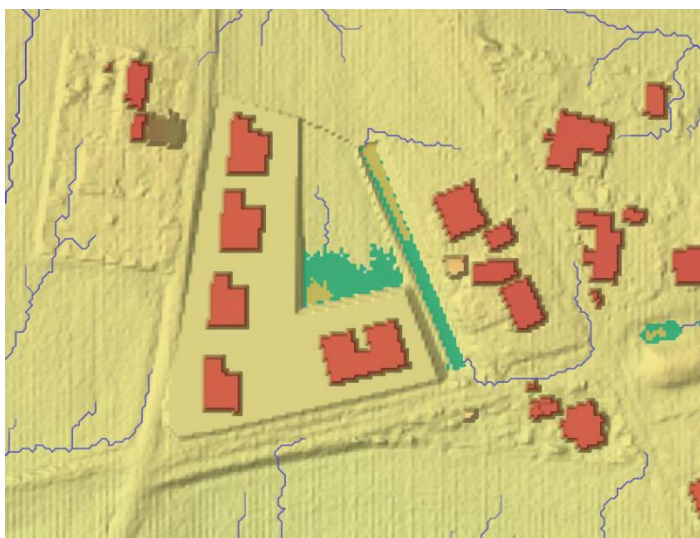
Figur 14. Översvämning från skyfall (5 mm effektivt regn). inom planområdet. Grön motsvarar ett vattendjup på upp till 10 cm och gul ett vattendjup mellan 10-30 (Scalgo, 2021).
