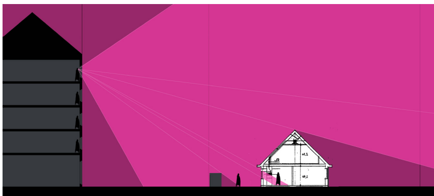
Insyn från byggrättens andra och femte våning till grannfastigheter i öster.
