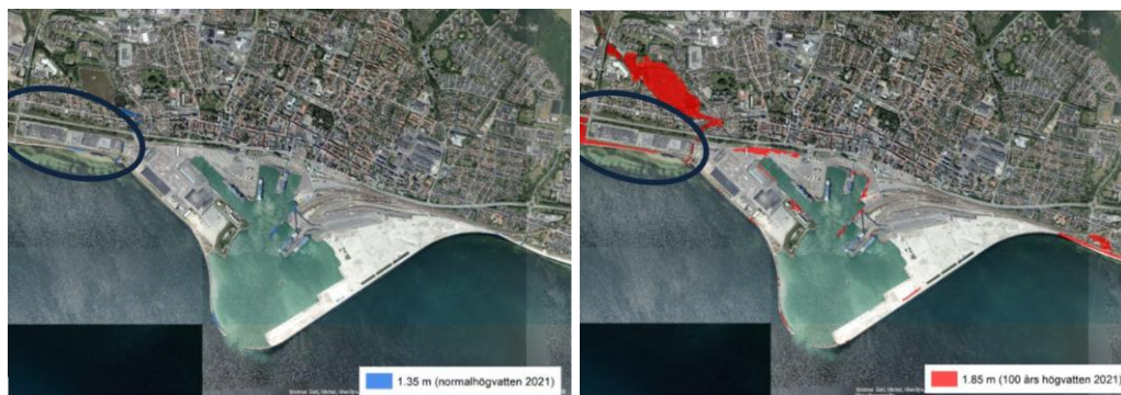
Figur 7. Översvämningskartor för de centrala delarna av Trelleborgs tätort, år 2021. Planområdet är markerat med en blå ring. Till vänster: normalhögsvatten. Till höger: 100-årshändelse. Bildkälla: COWI 2021.
