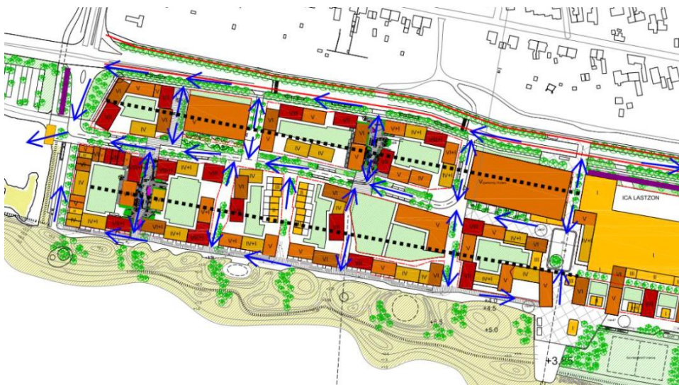
Figur 13. Princip för skyfallshantering i planområdet. Bildkälla: Ramböll 2021.
