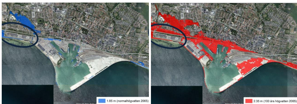
Figur 9. Översvämningsskator för de centrala delarna av Trelleborgs tätort, år 2065. Planområdet är markerat med en blå ring. Till vänster: normalhögvatten. Till höger: 100-årshändelse. Bildkälla: COWI 2021.
