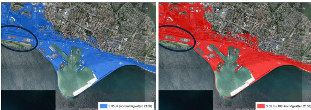
Figur 11. Översvämningskartor för de centrala delarna av Trelleborgs tätort, år 2150. Planområdet är markerat med en blå ring. Till vänster: normalhögvatten. Till höger: 100-årshändelse. Bildkälla: COWI 2021.
