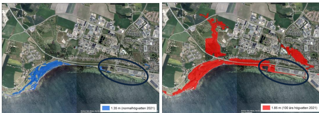
Figur 6. Översvämningsskador för de västra delarna av Trelleborgs tätort, år 2021. Planområdet är markerat med en blå ring. Till vänster: normalhögvatten. Till höger: 100-årshändelse. Bildkälla: COWI 2021.
