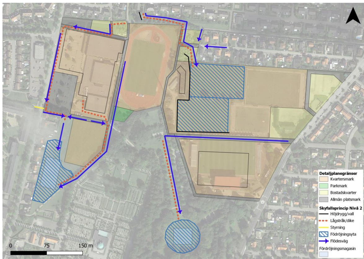
Figur 41. Princip för skyfallshantering för nivå 2.
