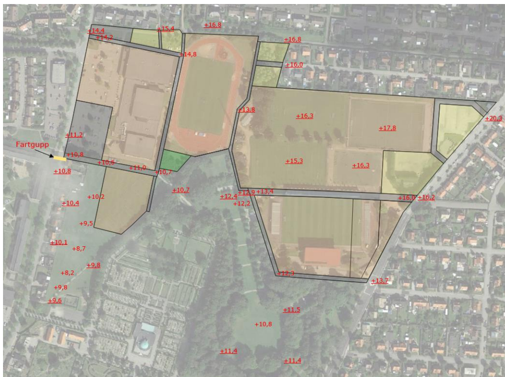
Figur 23. Övergripande höjdsättning för skyfallsprincip nivå 1. understrukna höjder är befintliga marknivåer som bevaras. Ej understrukna är nya föreslagna höjder.
