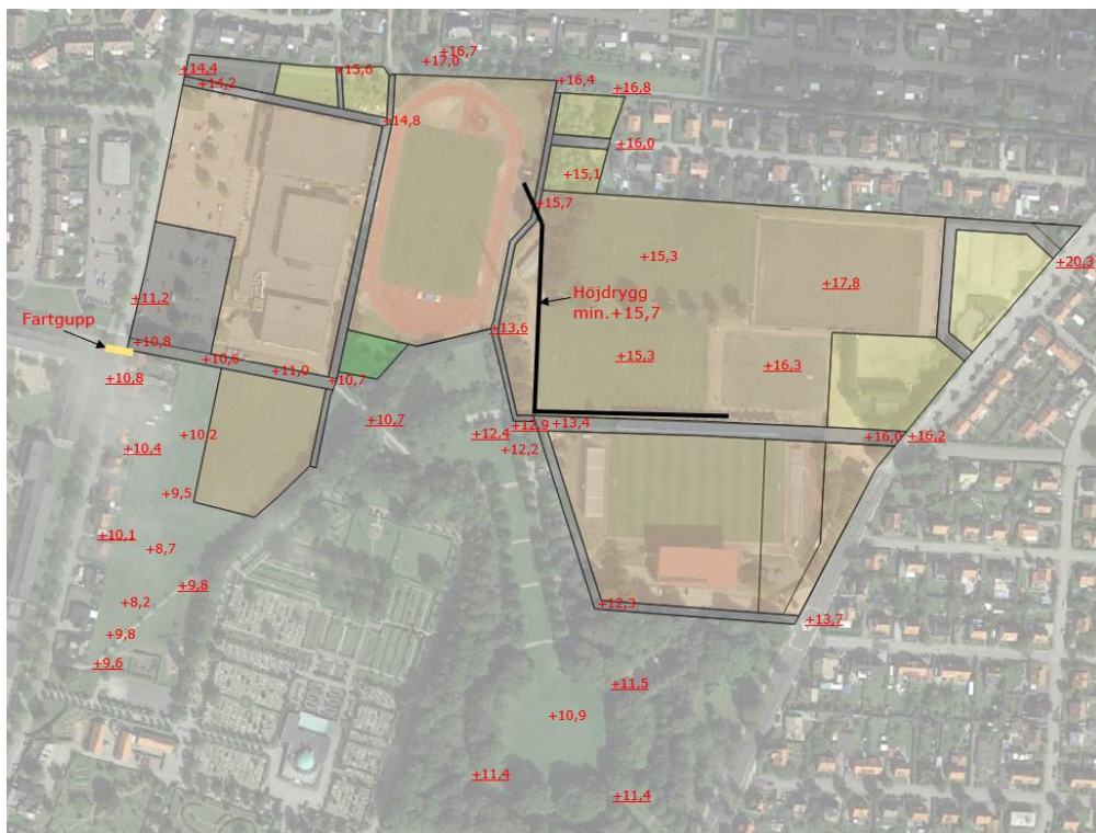
Figur 24. Övergripande höjdsättning för skyfallsprincip nivå 2. understrukna höjder är befintliga marknivåer som bevaras. Ej understrukna är nya föreslagna höjder.
