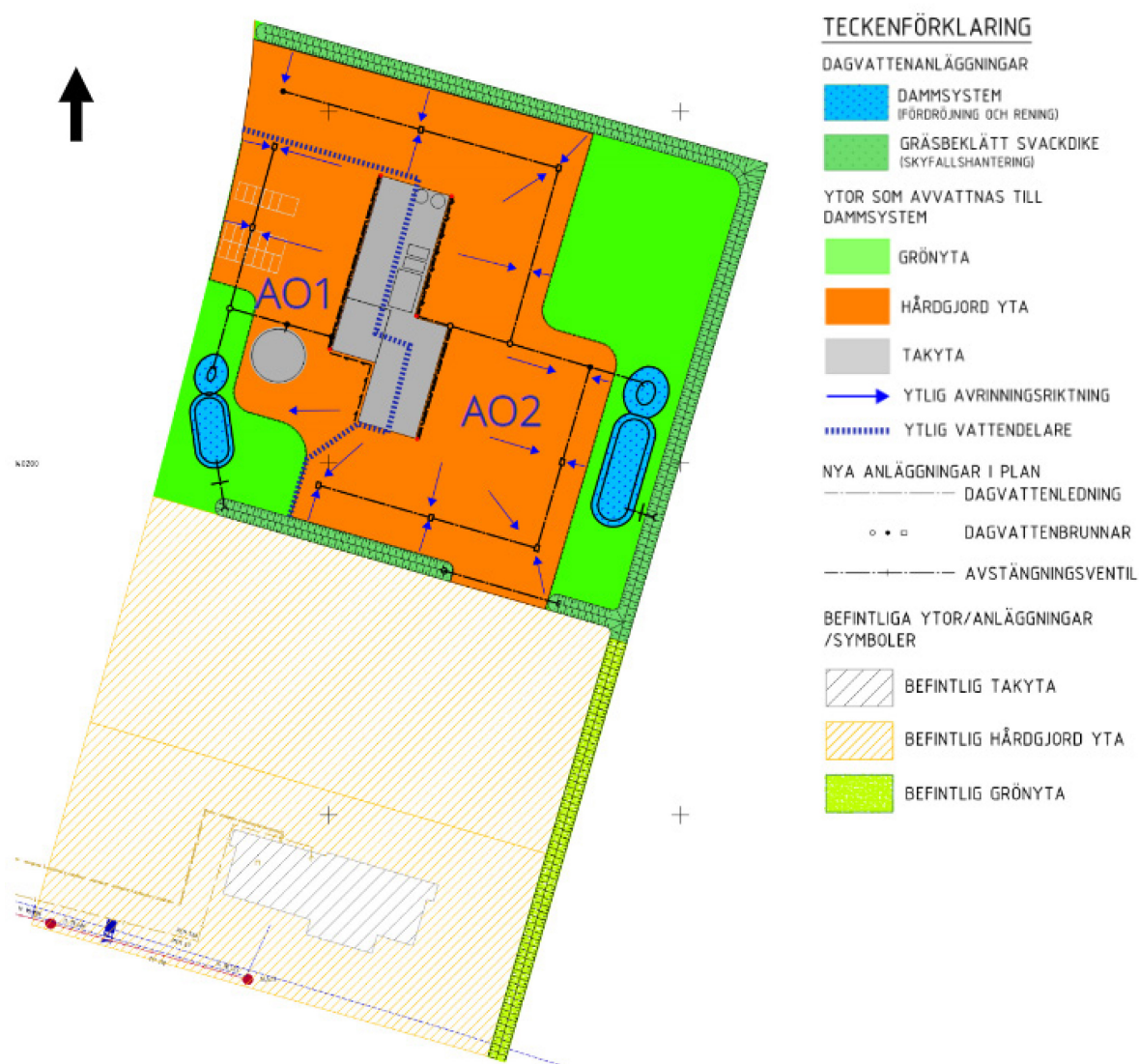
Figur 4.4. Preliminär skiss på verksamhetsområde med dagvattendammar och avrinning för det tillkommande verksamhetsområdet. Källa: Dagvattenutredning, Bilaga C5.
