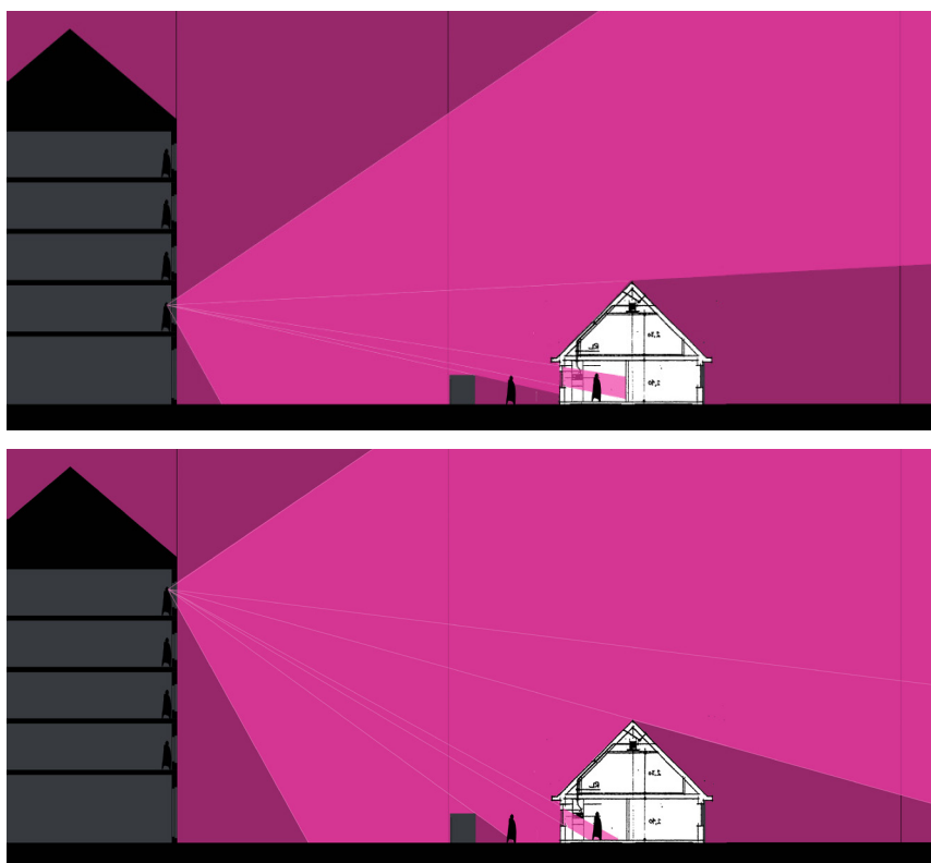
Insyn från byggrättens andra och femte våning till grannfastigheter i öster.
