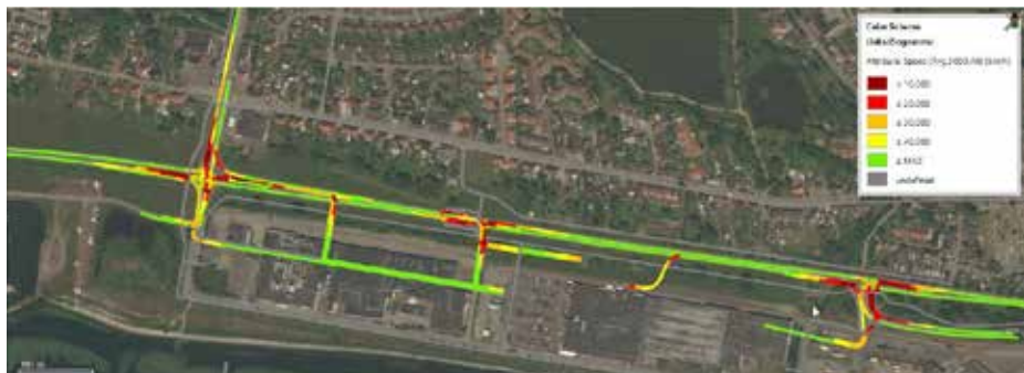
Heatmap som visar hur trafiksituationen ser ut med tillkomna korsningspunkter på E6. Medelhastighet på förmiddag
