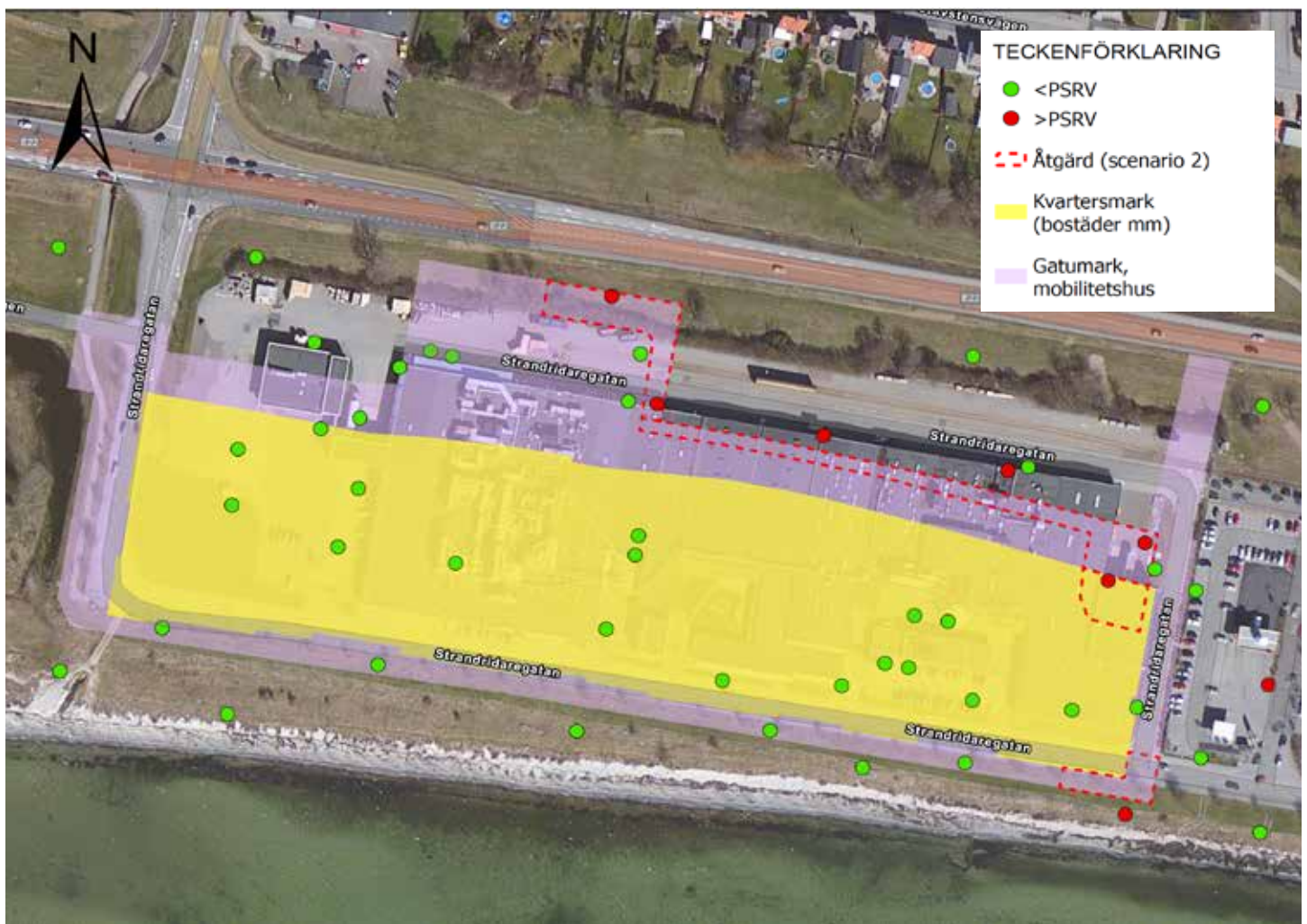
Karta som illustrerar föreningssituationen. Röd punkt visar förhöjda värden för PSRV där sanering krävs.
