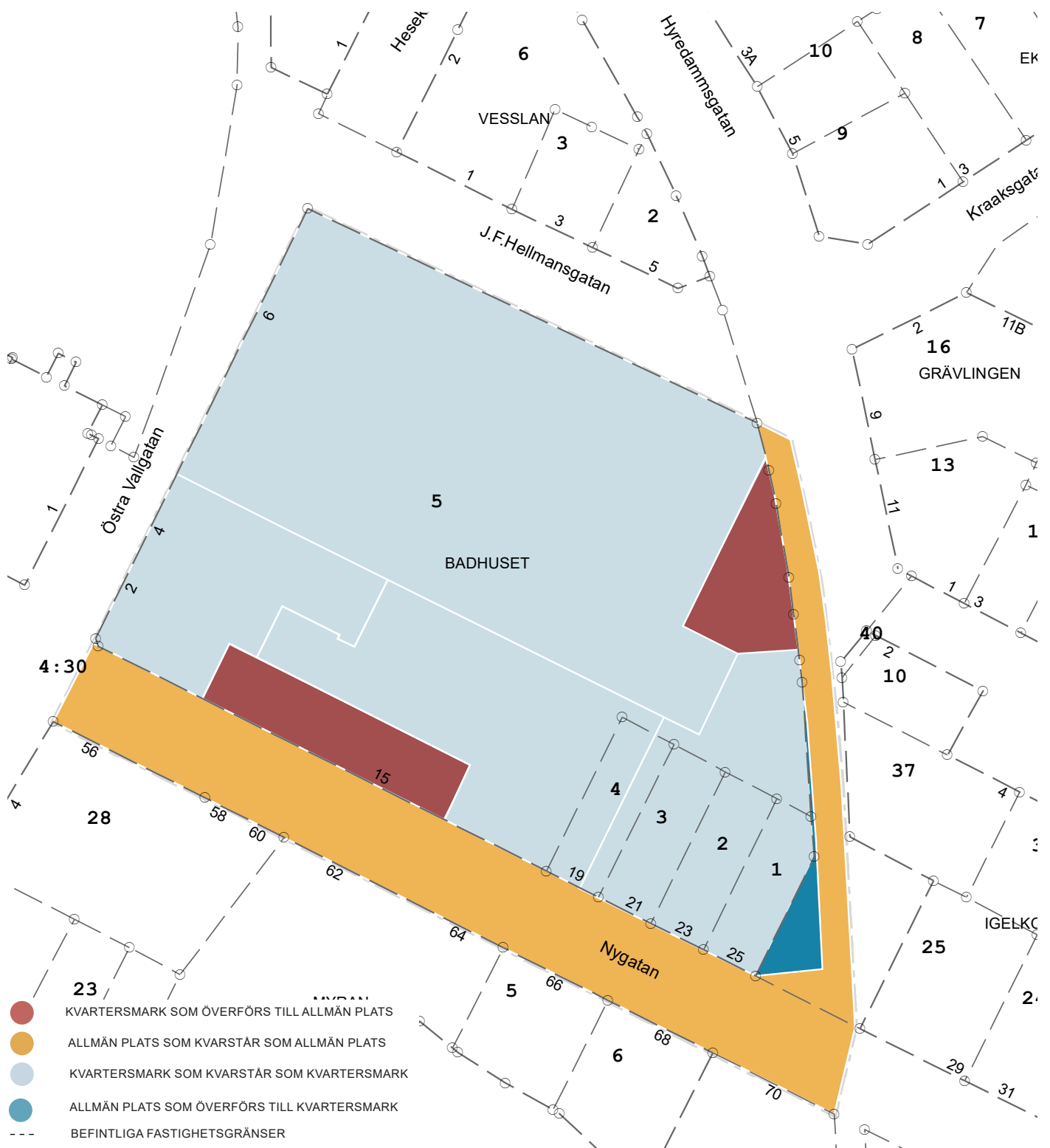
Fastighetskonsekvenskartan visar hur marken inom området fördelas som kvartersmark och allmän plats.
