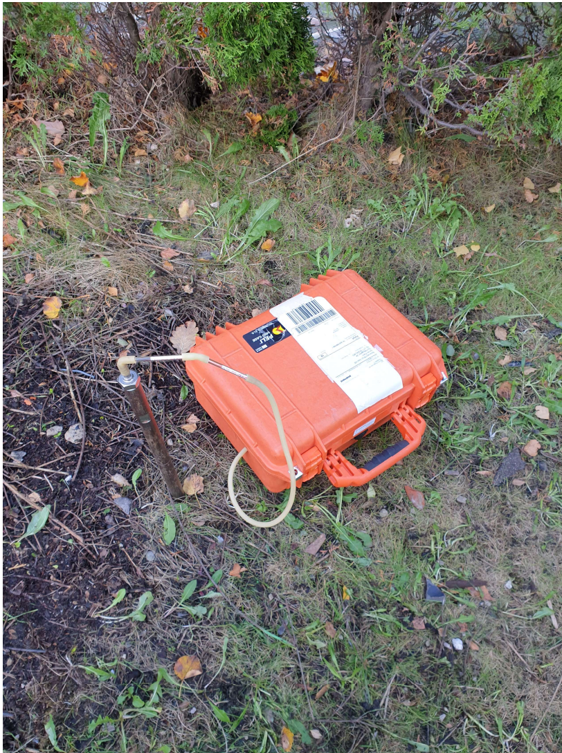
Figur 8. Provtagningspjut kopplat till adsorbentrör och en pump i väskan.
