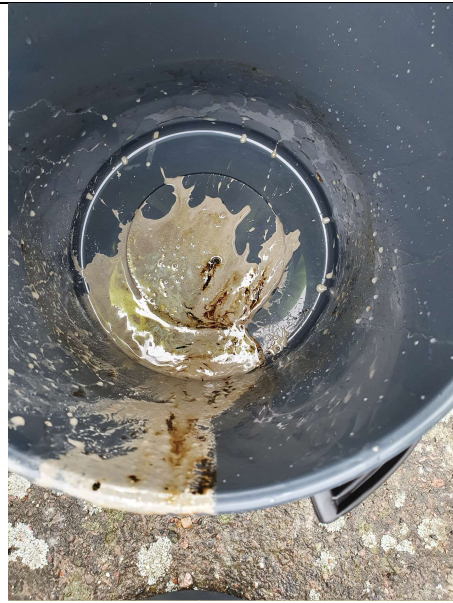
Figur 5. Efter rensumpning grundvattenrör 1846 morän.
