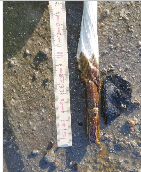
Figur 4. Resultat Fluteliner-test grundvattenrör 1836 morän.
