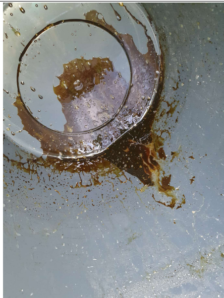
Figur 3. Efter rensumpning i grundvattenrör 1836 morän.
