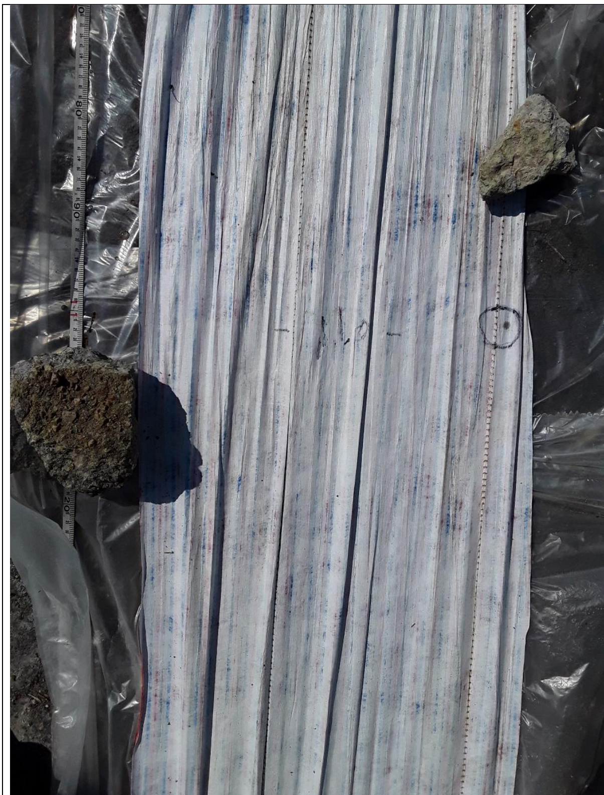
Figur 1. Första indikationen på fri fas förorening påträffas på 11,0 m u my. 1 fläck på ca 1cm.
