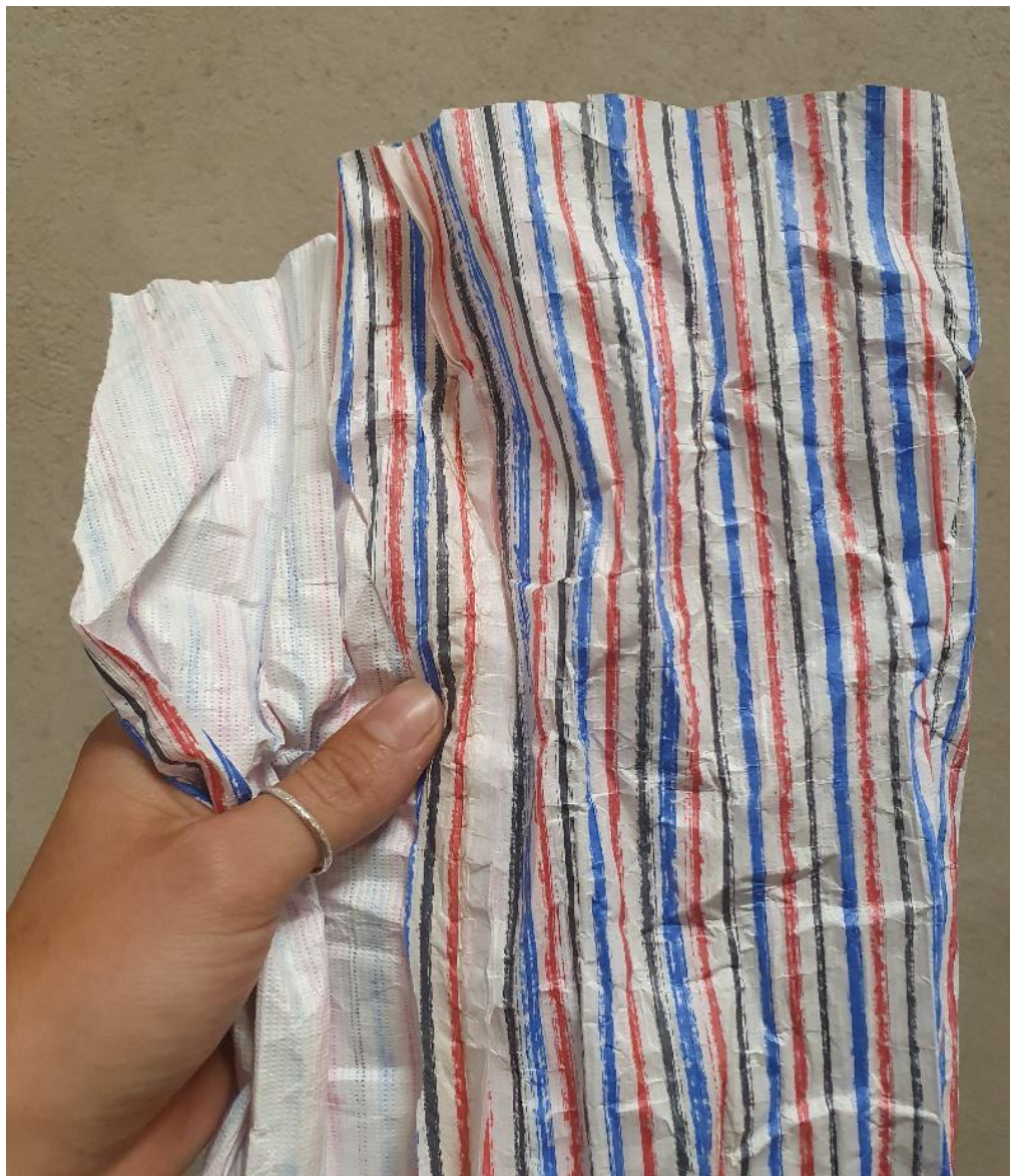
Figur 8. NAPL-liner, "indikatortyg" som sitter på FLUTE-linern. Tyget fläckas av organiska vätskor i fri fas, men inte vattenlösta föroreningar.
