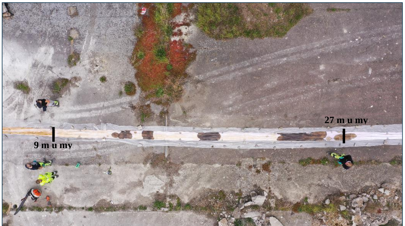
Figur 12. Drönarfoto över upptagen NAPL-liner efter utförd undersökning (BB22). Texten i bilden visar ungefärligt djup under markytan. De stora mörka fläckarna som syns tydligt har orsakats av direktkontakt med fri fas av kreosotliknande olja.
