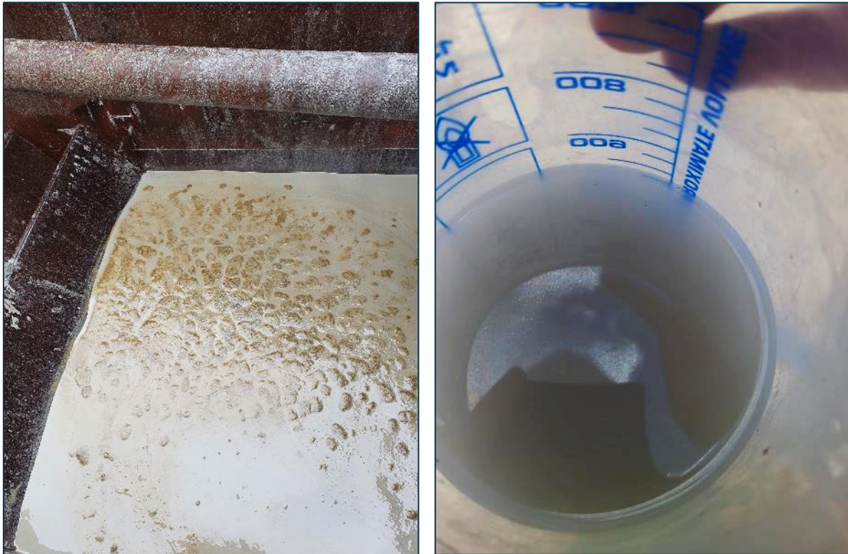
Figur 6. Till vänster: synlig fri fas kreosotolja i kax-containern vid borrning av BB25. Till höger oljeskimrande vatten från cirka 12 meters djup i BB32.
