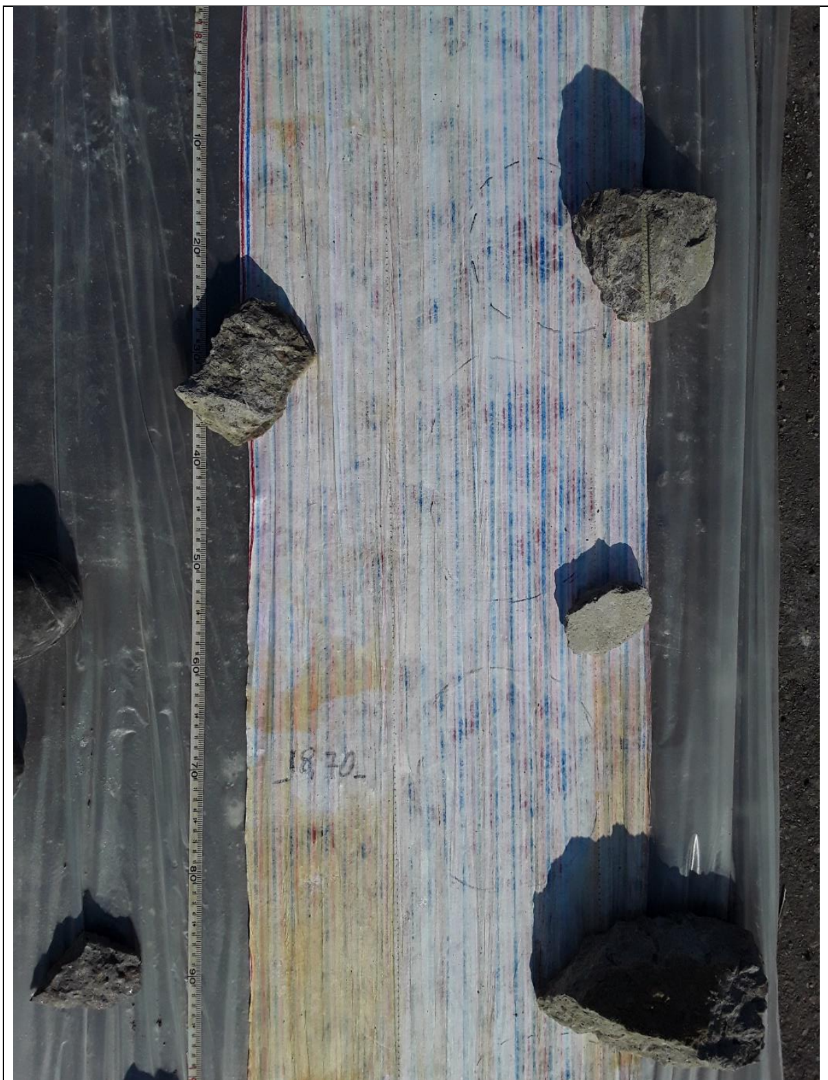
Figur 3. Indikationer på höga halter av förorening noterades mellan 17,80-19-20 m u my.
