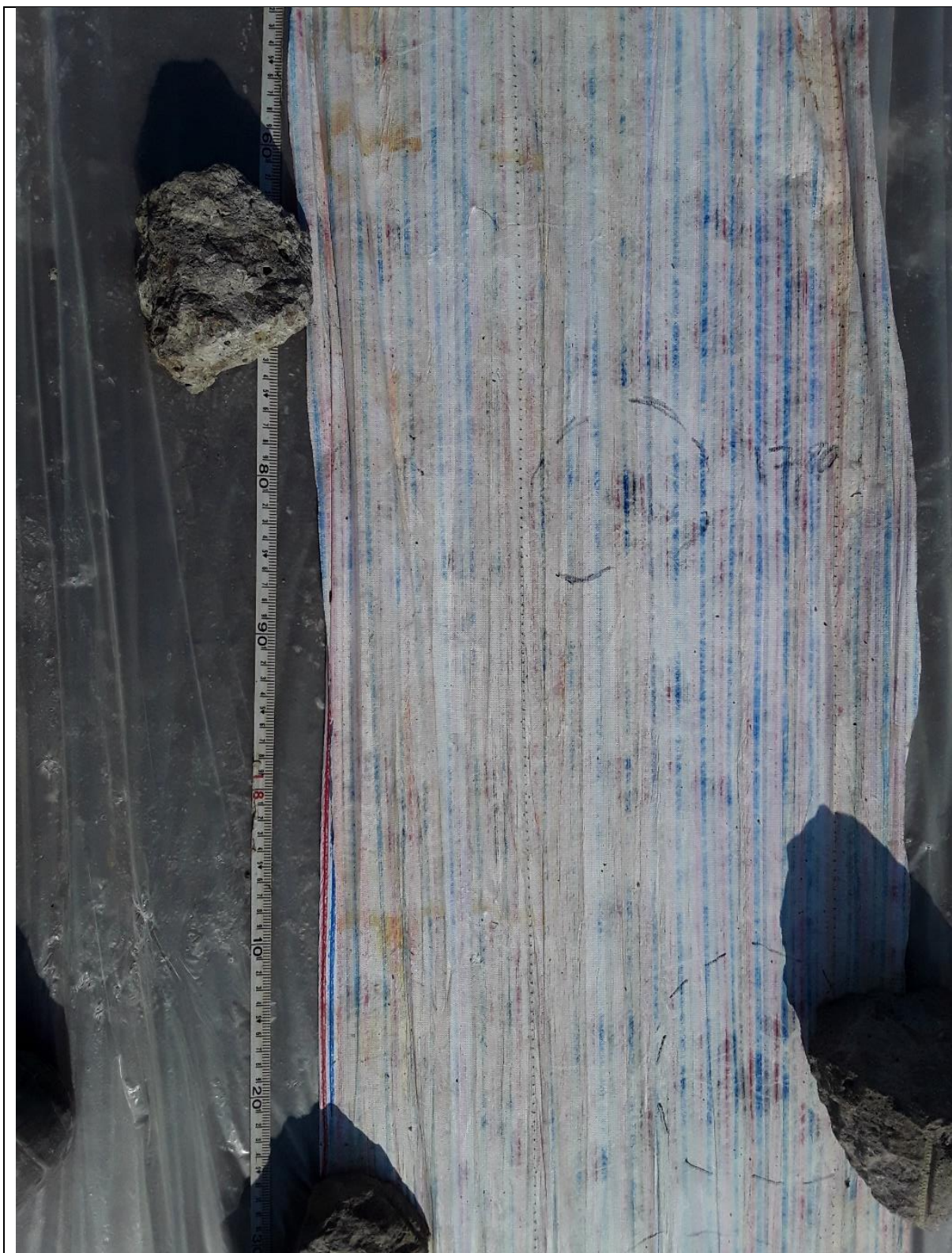
Figur 2. Indikationer på höga halter av förorening noterades mellan 17,80-19-20 meter under markytan (m u my).
