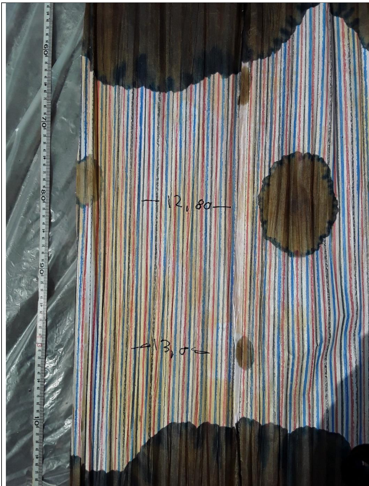
Figur 3. 3 medelstora fläckar (ca 0,4–1,2 cm) noterades mellan 12,75–13,00 m u my.
