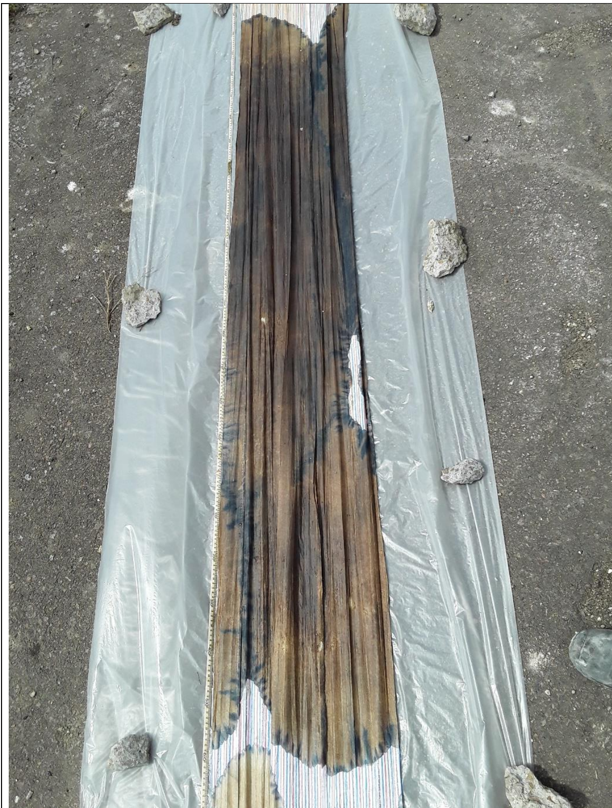
Figur 10. En stor fläck bestående av troligtvis två källor noterades mellan 19,30–21,60 m u my.
