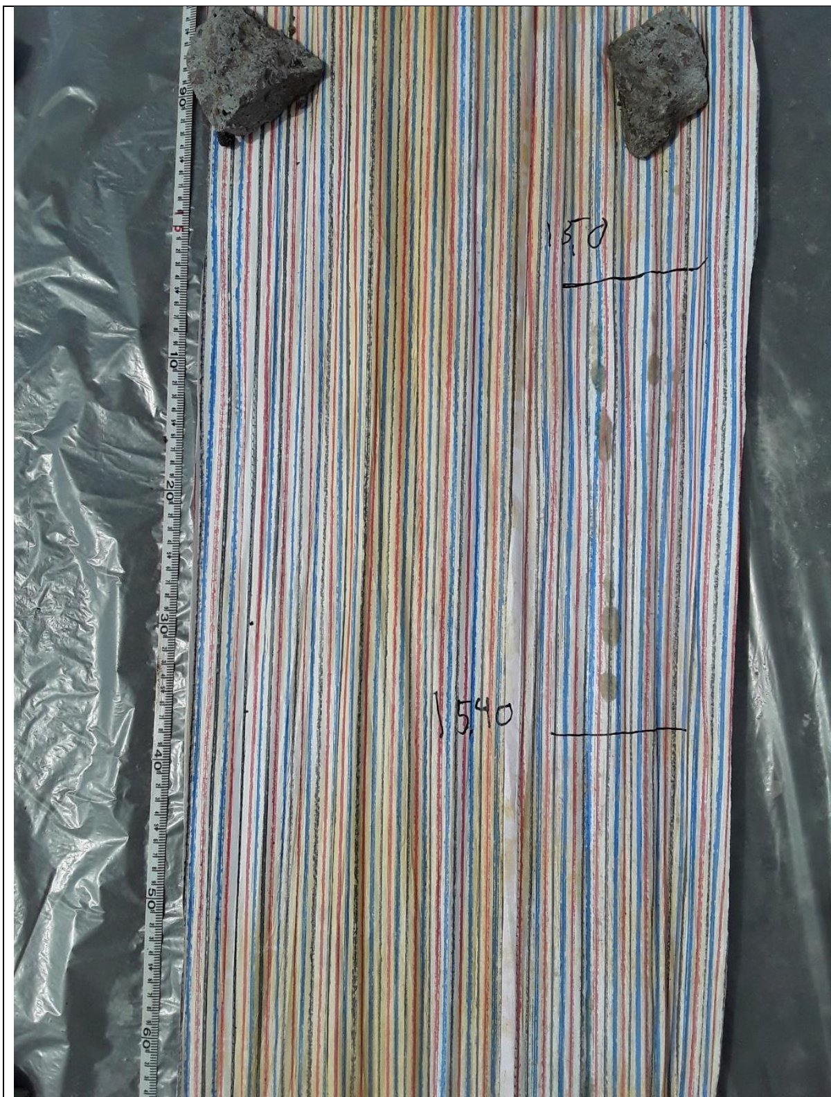
Figur 6. Flera mindre fläckar (ca 0,5-2,0 cm) noterades mellan 15,0-15,40 m u my.
