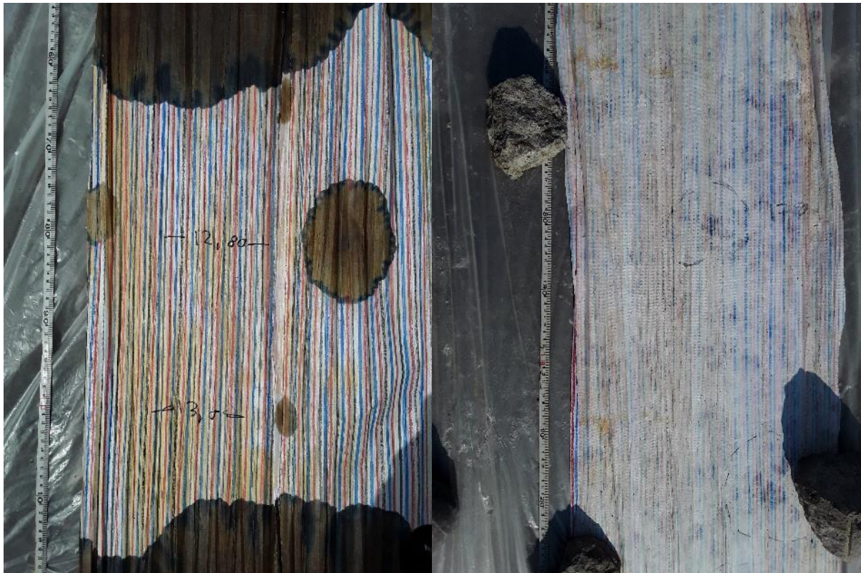
Figur 13. Vänster: Tydlig indikation av fri fas förorening (BB22). Höger: Indikation höga lösta halter (sannolikt mättnad), men ej fri fas (BB31).
