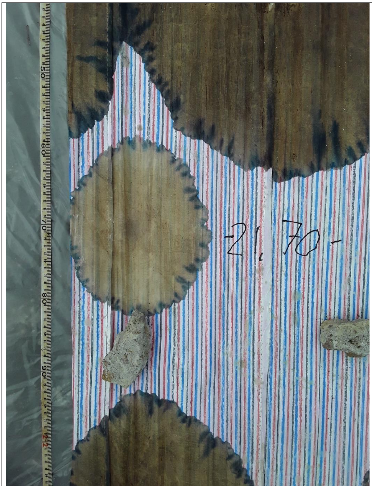
Figur 11. En fläck (ca 2dm) noterades mellan 21,55–21,80 m u my.
