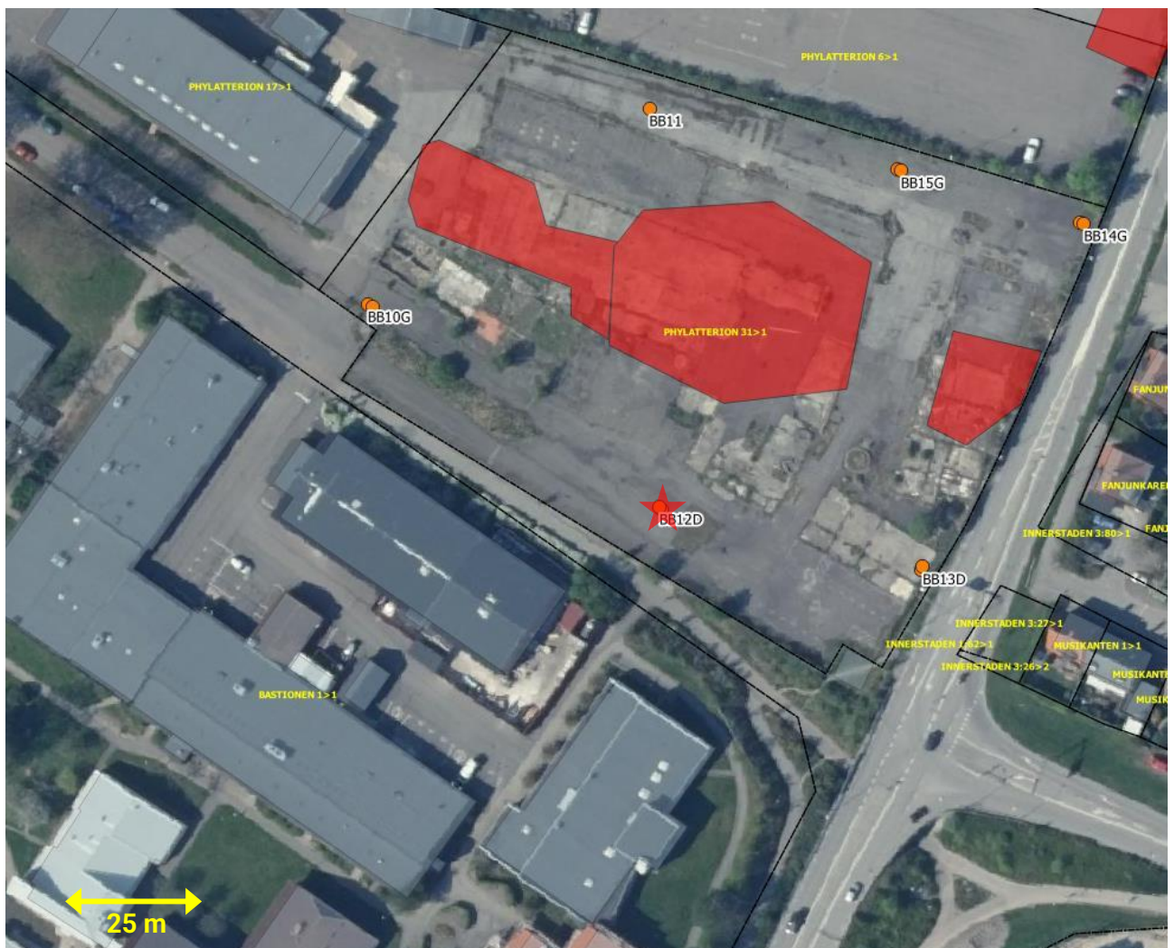
Figur 1. Tolkade källområden med fri fas/höga halter i lermoränen är markerade med röd färg. Fri fas kreosotolja påträffades även i kalkberget vid BB12.
