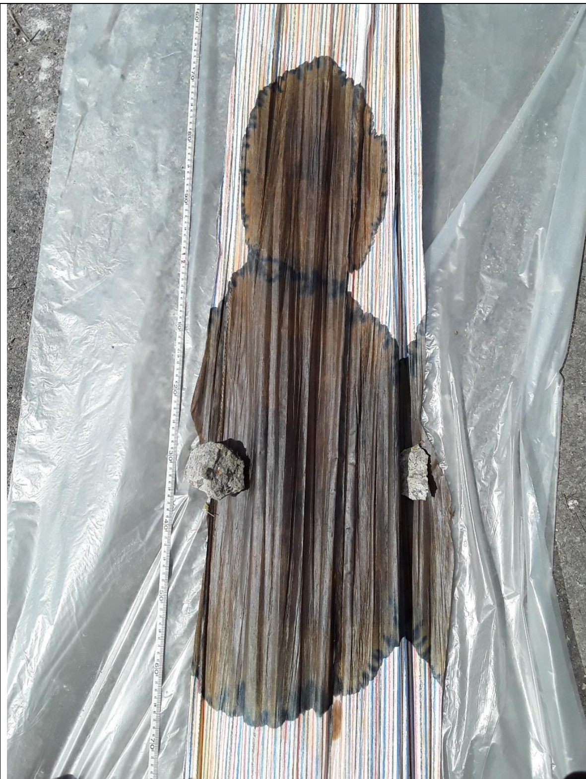
Figur 2. Två större fläckar noterades mellan 11,70–12,05 och 12,05–12,65 m u my.
