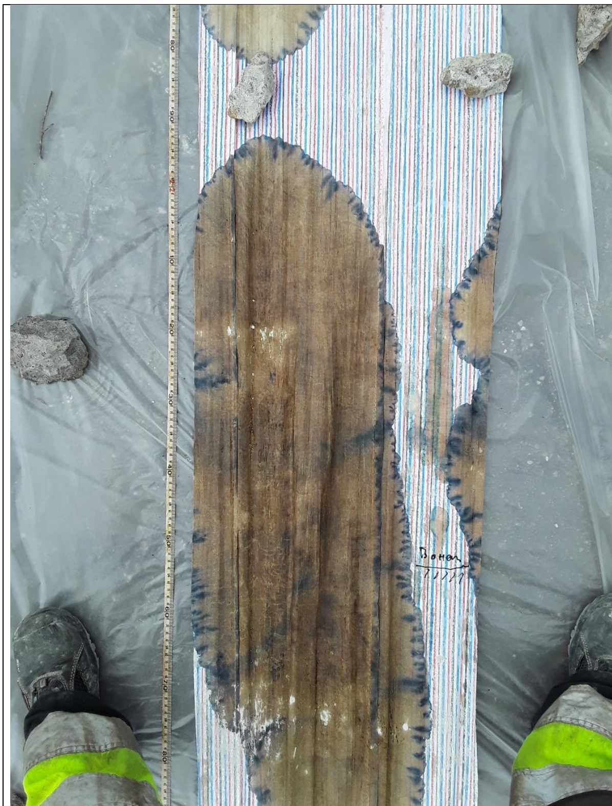
Figur 12. En fläck noterades från 21,90 till botten på FLUTE (22,5 m u my).
