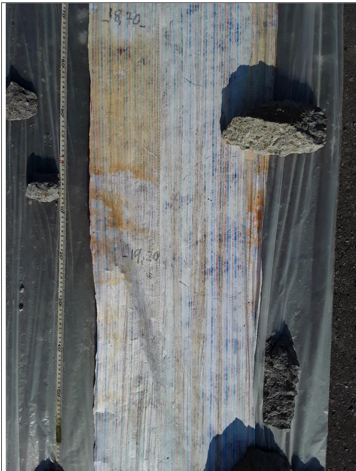
Figur 4. Indikationer på höga halter av förorening noterades mellan 17,80-19-20 m u my.
